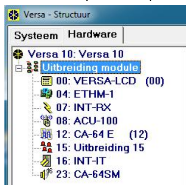
Fig. 12. Lijst van aangesloten apparaten op de centrale, weergegeven in het "Hardware" tabblad, "Versa – Structuur" scherm (voorbeeld van een configuratie).
