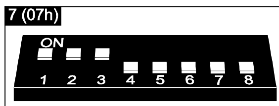
Fig. 13. Instellen adres in de INT-RX uitbreiding.
