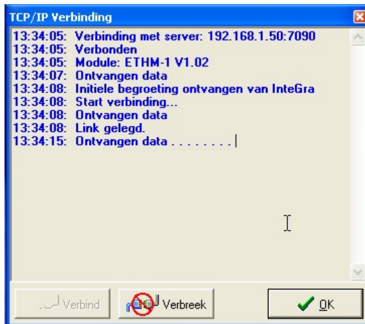
Fig. 6. "TCP/IP verbinding" venster in het DLOADX programma, met de boodschap getoond wanneer er een poging tot verbinding wordt gemaakt.
