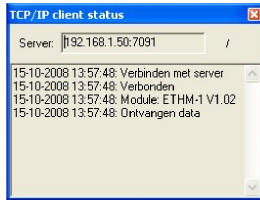
Fig. 8. GUARDX verbinding venster met de informatie over de status van de communicatie met de module.
